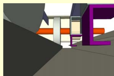
密集式檔案架防傾倒卡榫示意圖
