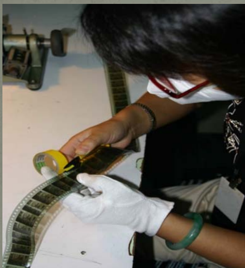
齒孔裂痕，以膠帶包邊， 防止滑片
