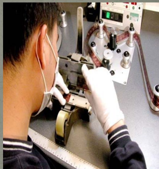
利用膠質接片器剪接斷片
