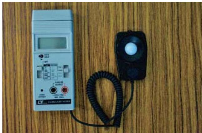
圖 39 照度測量儀器
