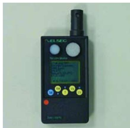
圖 43 四合一紫外線測量儀器
